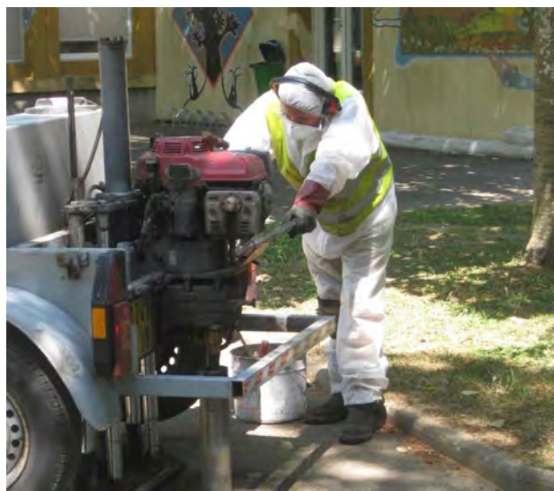
« carottage » pour analyse avant travaux, si présence d'amiante dans les cours d'école de Poitiers
