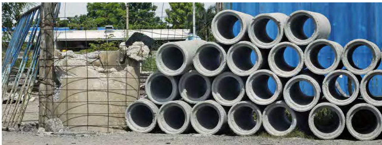
Canalisations en ciment contenant de l'amiante
