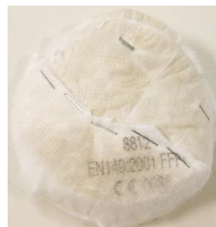
Fig. 31 : Encrassement du masque anti-poussières FFP1 après utilisation
