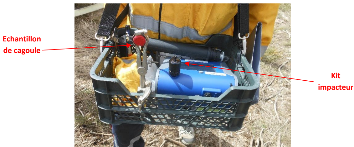
Fig.51 : Appareil Dustrak portable pour la mesure des particules fines en condition de terrain
