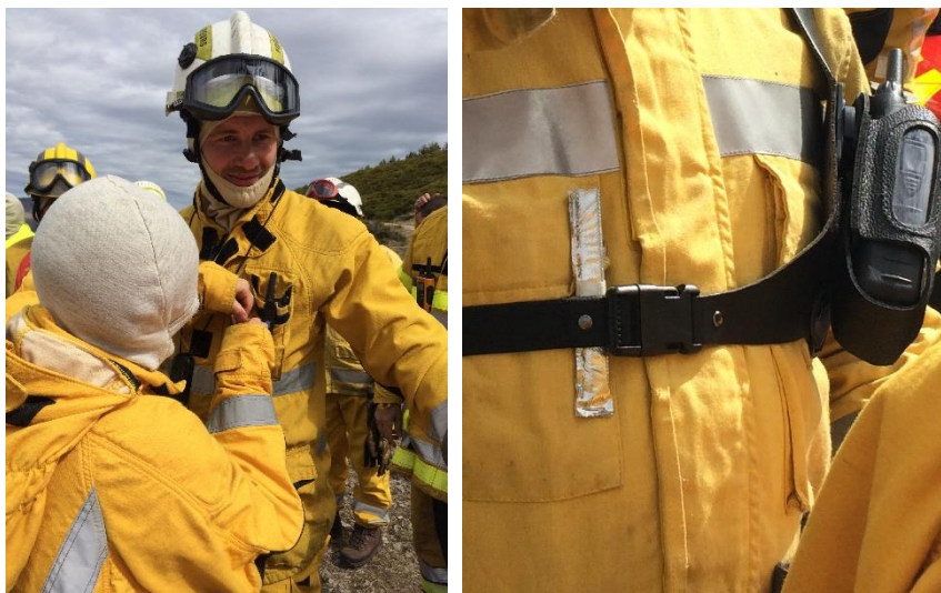
Fig.54 : Fixation des tubes passifs pour le dosage du CO et du Formaldéhyde
