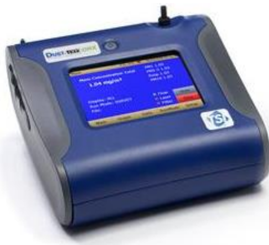
Fig.11 : Compteur de particules DUST TRACK II
