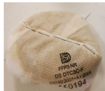
Fig. 35 : Encrassement du masque anti-poussières FFP3 après utilisation
