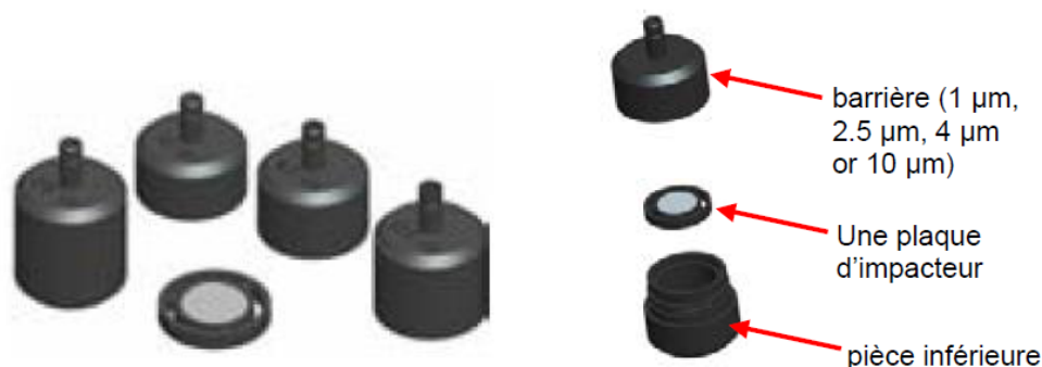
Fig.12 : Eléments de séparation des fractions de coupe du « Kit impacteur »
