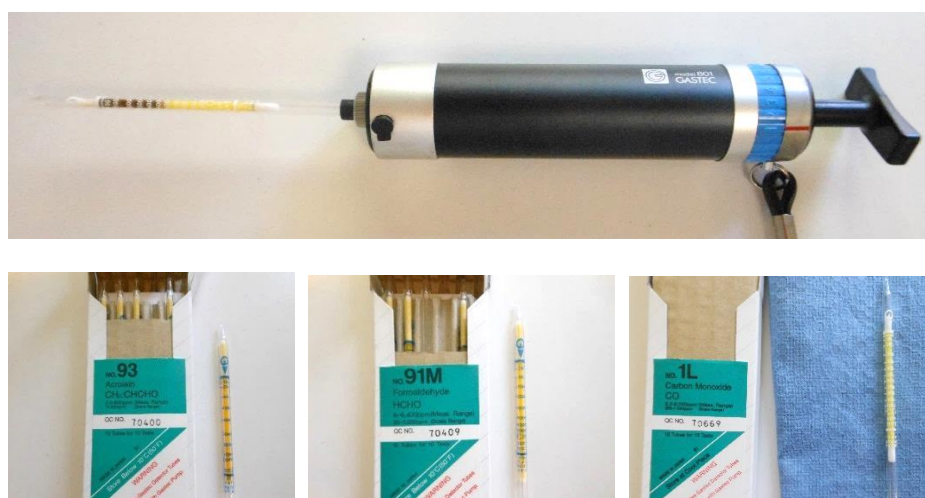
Fig.10 : Pompe de prélèvements et tubes colorimétriques GAZDETECT
