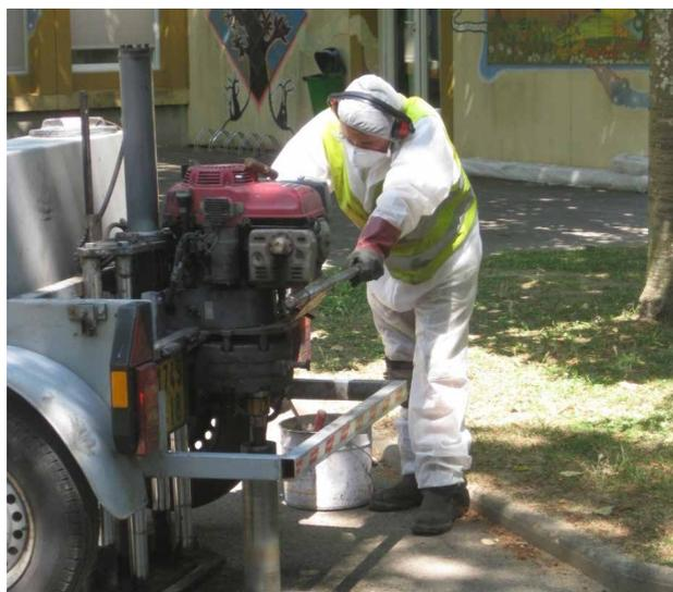
*« carottage » pour analyse avant travaux, si présence d'amiante dans les cours d'école de Poitiers*
